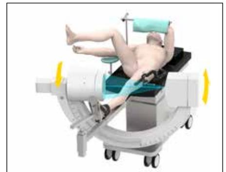
Fig. 108: Giro del arco en C hacia arriba
