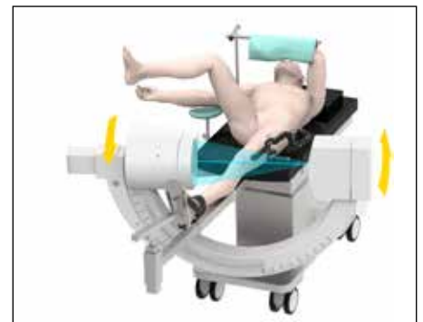
Fig. 108: rodar o braço em C para cima
