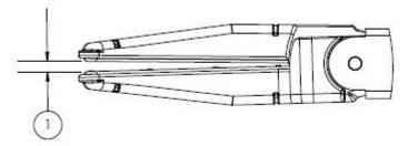
1 < 2 mm – Confirmez que les mâchoires sont en position fermée avant d'activer l'instrument de coupe.
