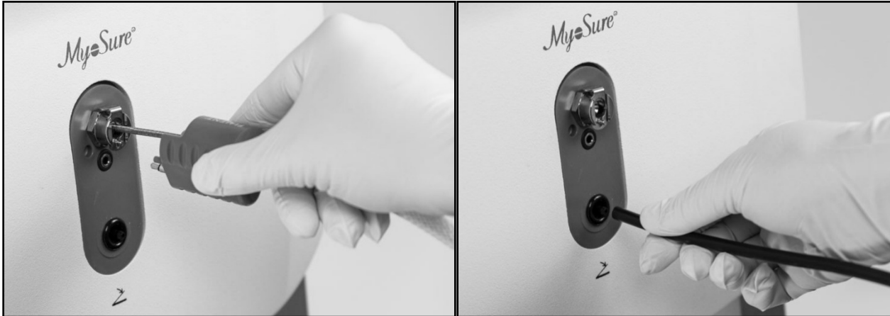
FIGURE 3 : INSÉRER LE CÂBLE D'ENTRAÎNEMENT ET LA PÉDALE DANS LE SYSTÈME DE GESTION DES LIQUIDES FLUENT
