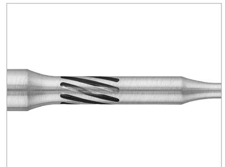
Verbindet Längsschwingung (longitudinal) und Drehschwingung (torsional) in einer nicht drehenden Bewegung mit 25.000 x pro Sekunde, mit der Knochen abgetragen wird, ohne das Weichgewebe zu verletzen.
