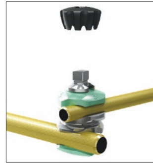
Step3 最終締結前にサムホイールを外します (一度外すと元に戻せません)
