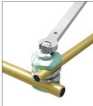
最終締結は Tレンチかスパナレンチを使用します
