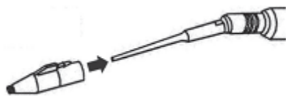
Hình 3- Lắp nắp tưới rửa
