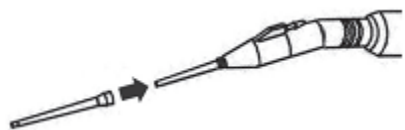
Hình 4- Lắp nắp bọc đầu mũi
