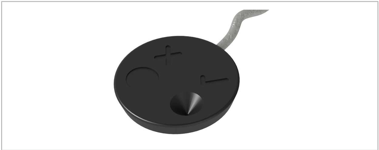
图 94 – 校准区域：患者跟踪仪电磁部件
