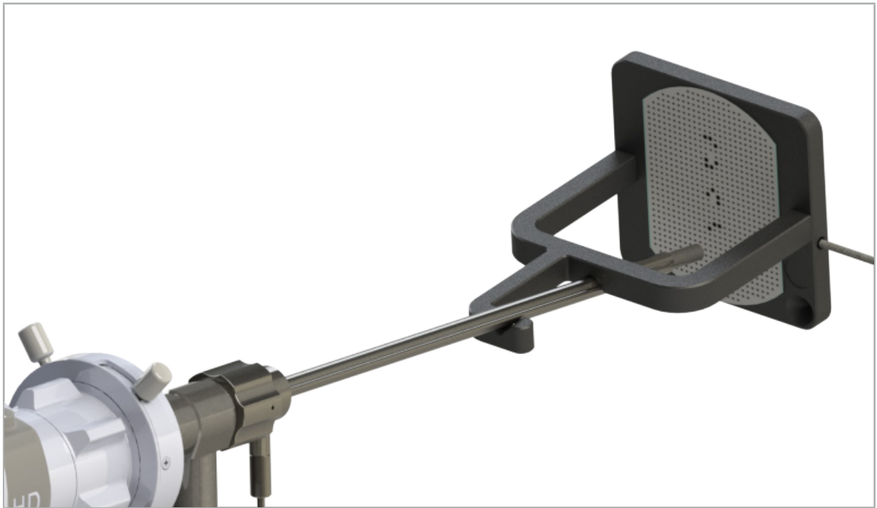
Hình 101 – Đèn nội soi được điều hướng trong khung hiệu chuẩn điện từ
