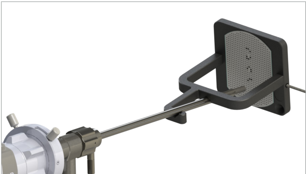
Bild 101 – Navigiertes Endoskop im elektromagnetischen Kalibrierkörper
