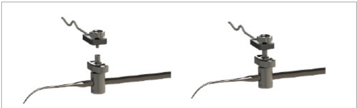
Figur 78 – Klargøring af instrumentklemme med elektromagnetisk universaltracker
