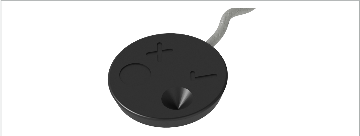
Figure 94 – Zones d'étalonnage : tracker patient électromagnétique
