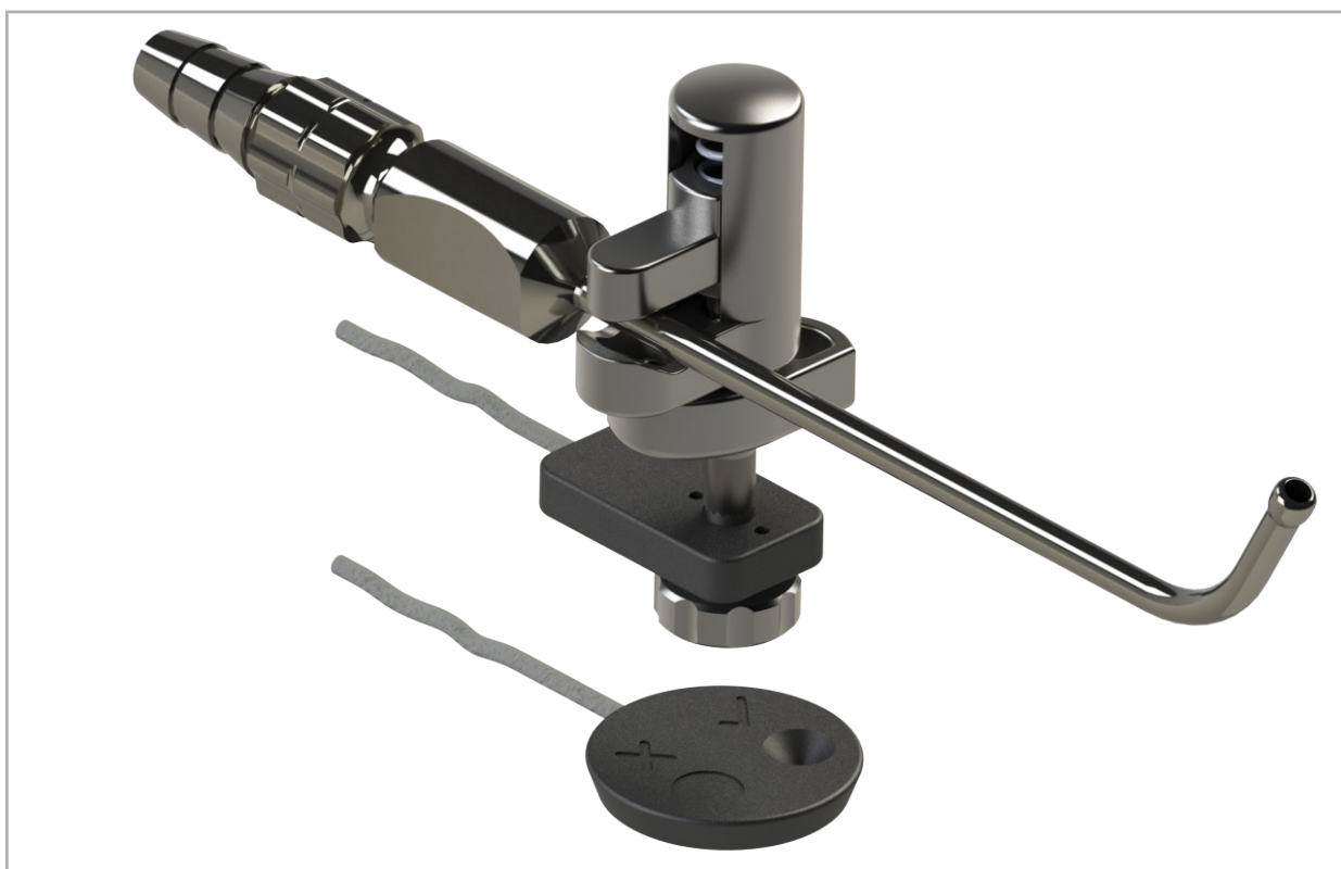
Figure 100 – Placer le tracker à l'envers sur le tracker patient pour réinitialiser l'étalonnage
