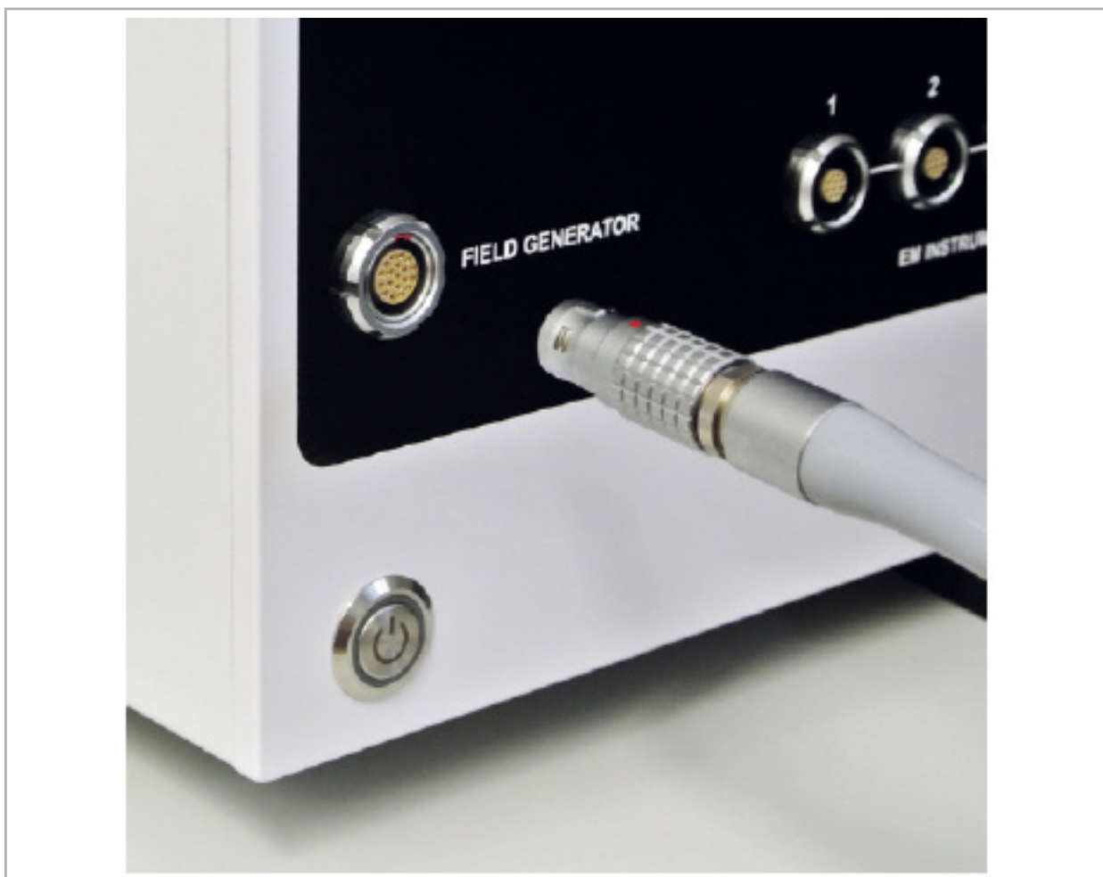
Afbeelding 65 – Aansluiting van de veldgeneratorkabel op de elektromagnetische navigatie-unit
