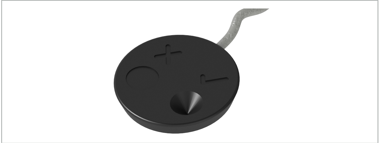
Figura 94 — Áreas de calibração: rastreador eletromagnético do paciente
