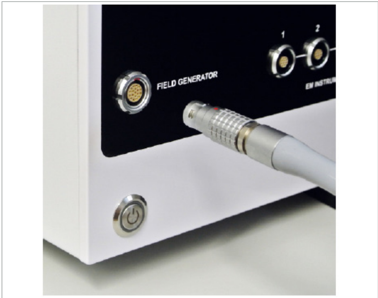
Figura 65: Conexión del cable del generador de campo a la unidad de navegación electromagnética
