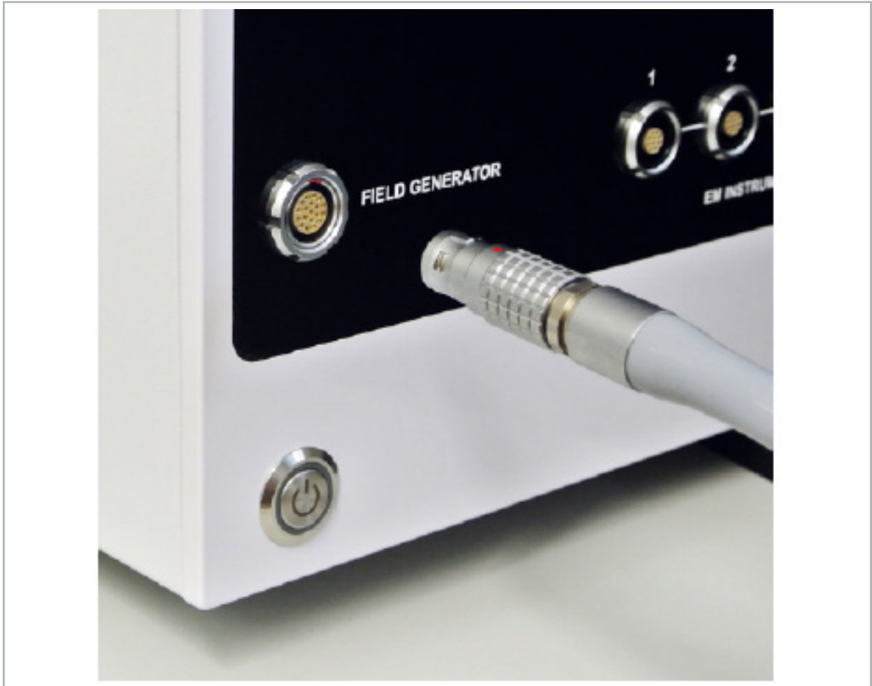
Kuva 65 – Kenttägeneraattorikaapelin kytkeminen sähkömagneettiseen navigointiyksikköön
