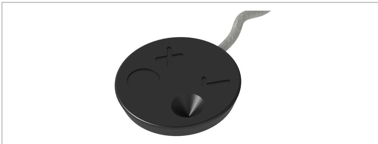
Rys. 94 — Obszary kalibracji: elektromagnetyczny tracker pacjenta
