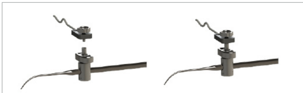
Hình 78 – Chuẩn bị Kẹp dụng cụ với Bộ theo dõi vận năng điện từ
