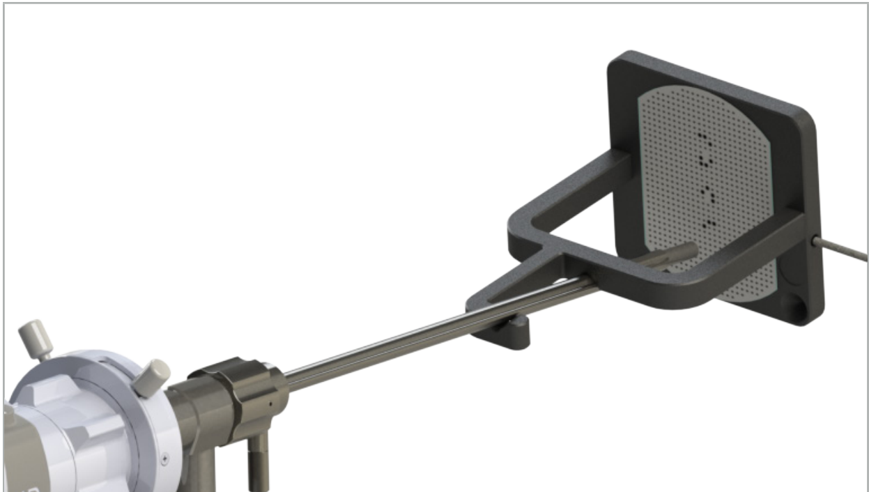
Figur 101 – Navigert endoskop i elektromagnetisk kalibreringsenhet
