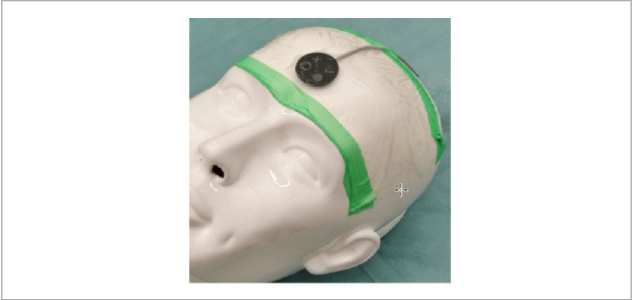
Şekil 70 - Hasta İzleyicinin Hastaya Sabitlenmesi
