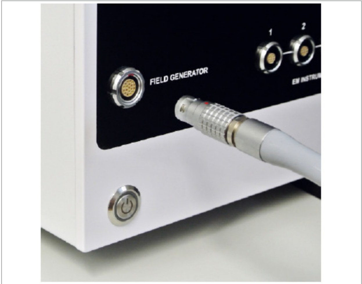
図 65 - 電磁界発生器ケーブルを電磁ナビゲーションユニットに接続する
