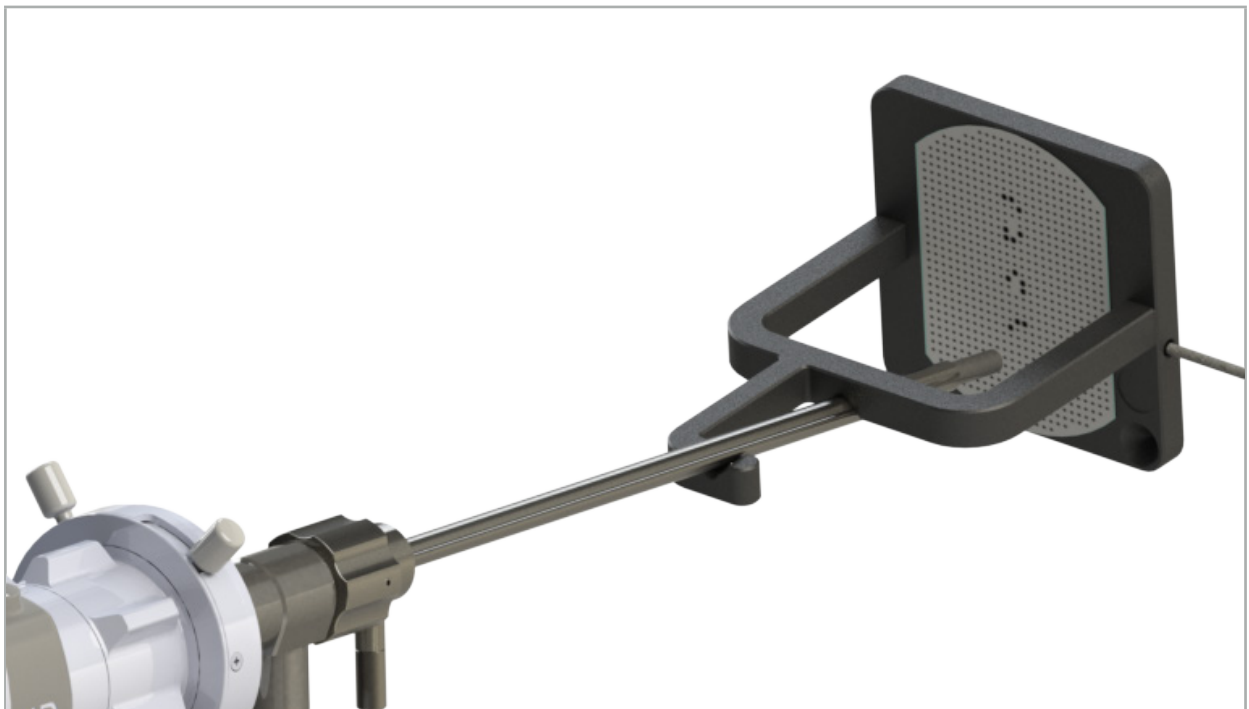
Figur 101 – Navigerat endoskop i elektromagnetisk kalibreringskropp
