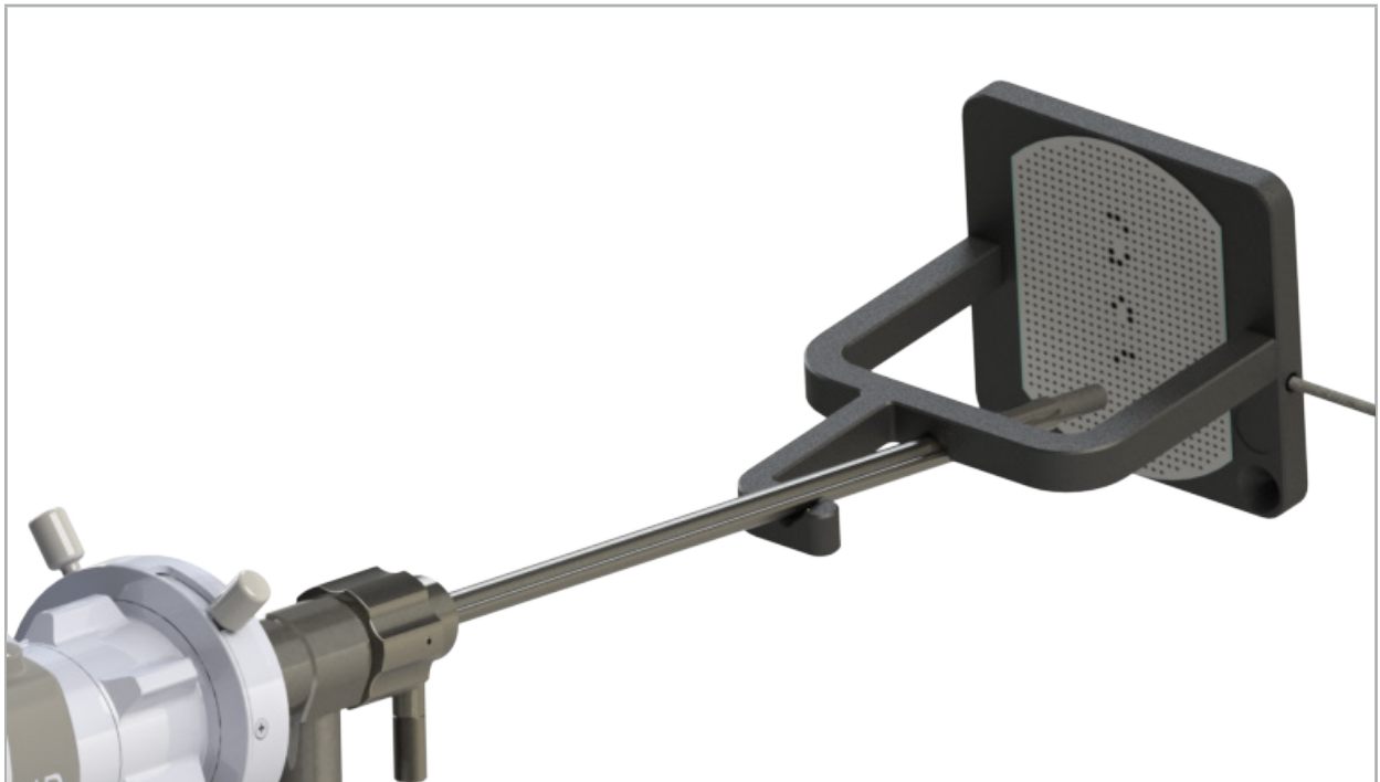
図100 - 較正をリセットするために患者用トラッカーの上でトラッカーを逆さまに保持する
