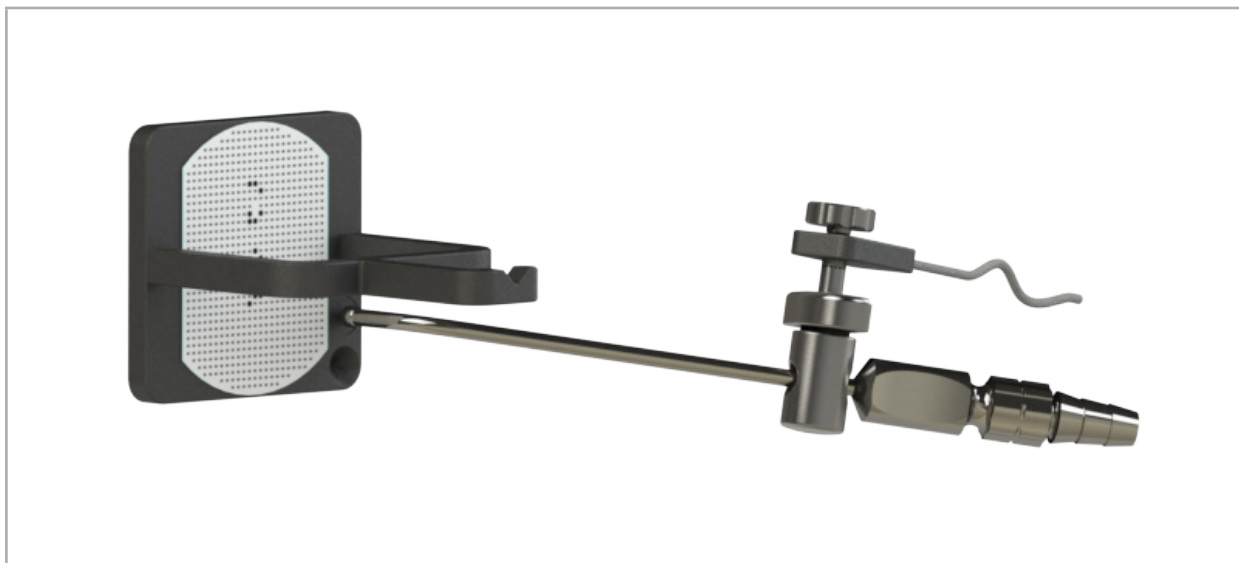
Εικόνα 97 – Βήμα βαθμονόμησης 2: Κράτημα του άκρου του εργαλείου στην (πάνω) πλάκα βαθμονόμησης
