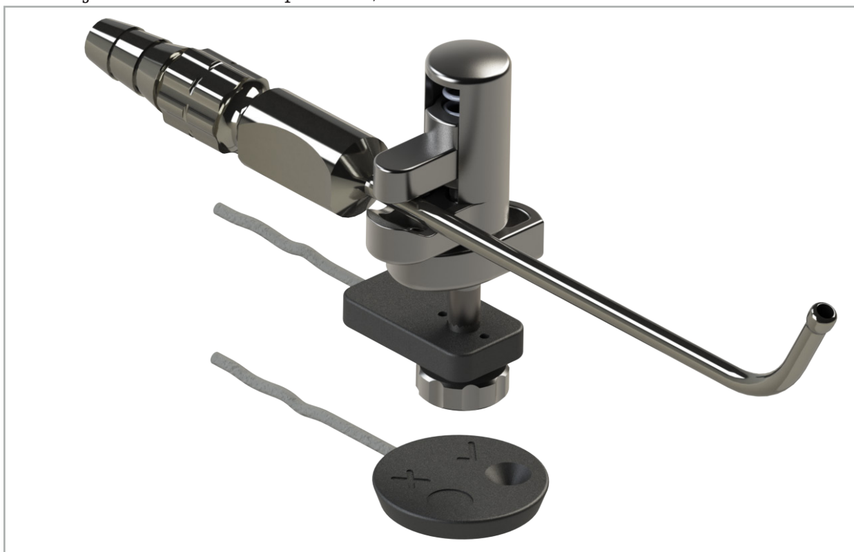
Figura 100: Mantener el tracker boca abajo sobre el tracker de pacientes para restablecer la calibración
