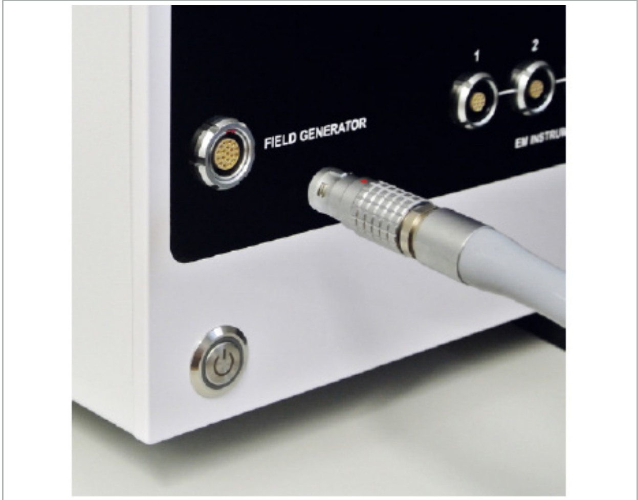
Hình 65 – Kết nối Cáp máy phát trường với Thiết bị điều hướng điện từ
