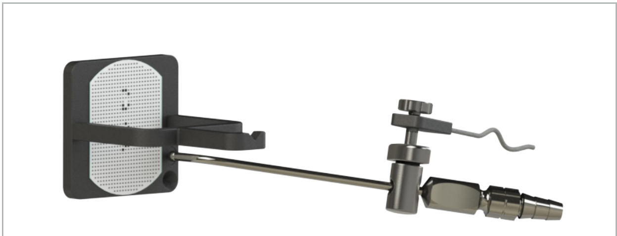
图 97 – 校准步骤 2：将仪器尖部保持在（上部）校准盘中
