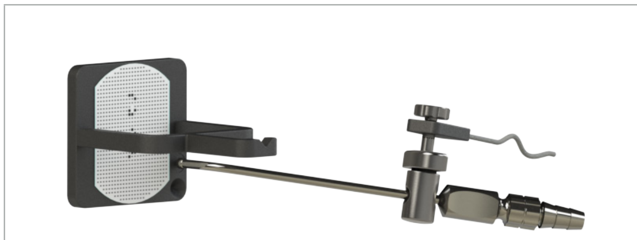
Hình 97 – Bước hiệu chuẩn 2: Giữ đầu tít của thiết bị với đĩa hiệu chuẩn (trên)
