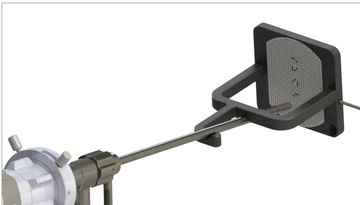
図101 - 電磁キャリブレーションボディ内のナビゲーション対象内視鏡
