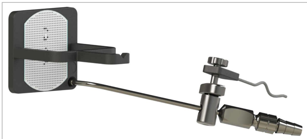
Hình 96 – Bước hiệu chuẩn 1: Giữ đầu tít của thiết bị vào nón hiệu chuẩn (dưới)
