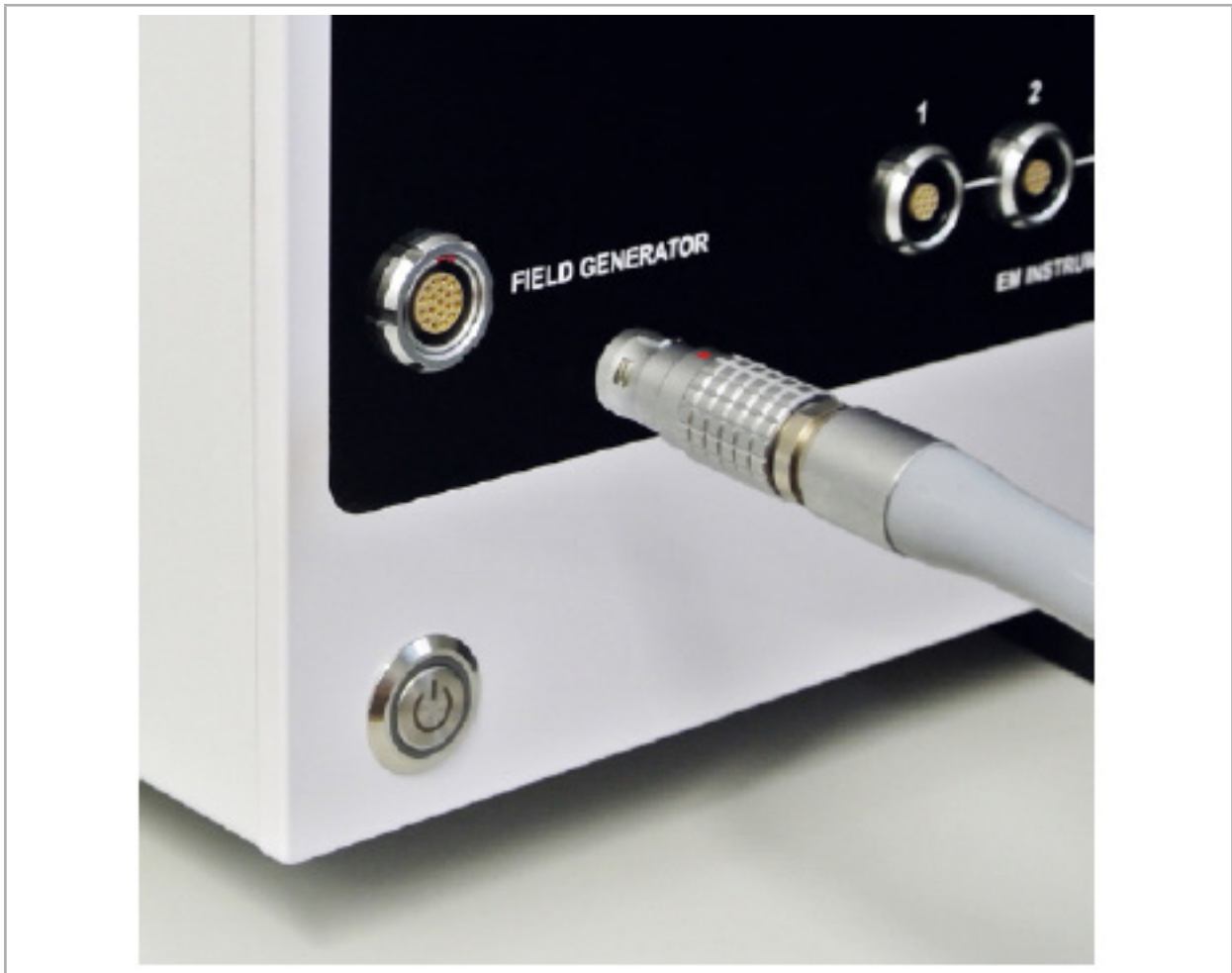
Bild 65 – Verbinden des Feldgeneratorkabels mit dem elektromagnetischen Navigationssystem
