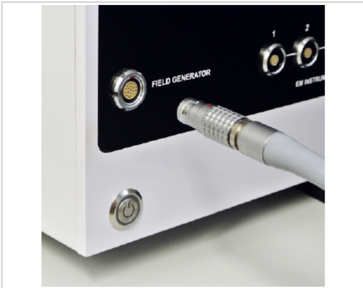
Rys. 65 — Podłączanie przewodu generatora pola do jednostki nawigacji elektromagnetycznej
