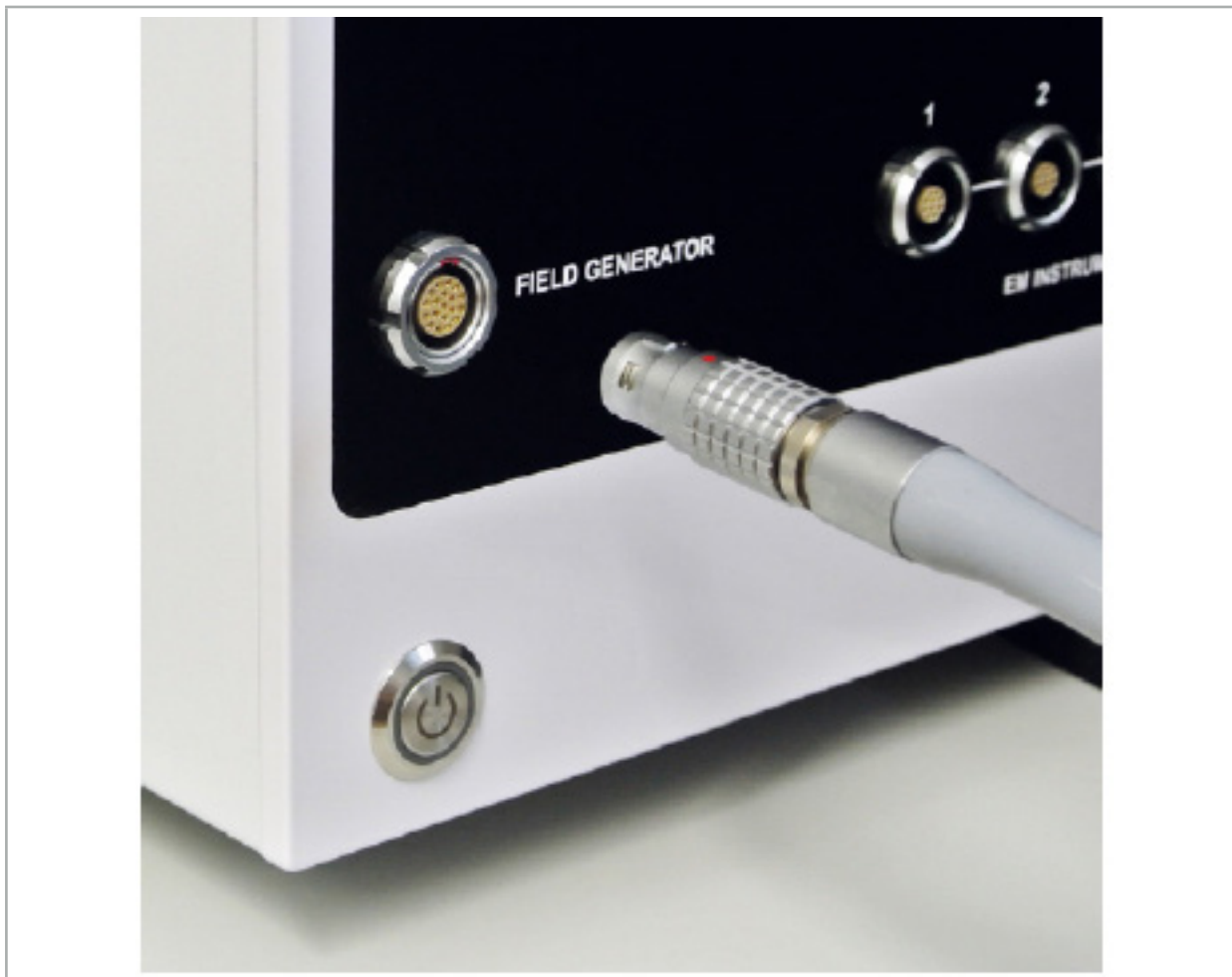
Figur 65 – Koble feltgeneratorkabelen til den elektromagnetiske navigasjonsenheten
