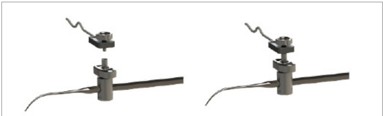
图 78 – 准备配有通用跟踪仪电磁部件的仪器钳
