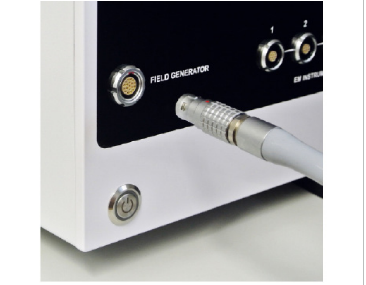
Şekil 65 - Saha Jeneratörü Kablosunun Elektromanyetik Navigasyon Ünitesine Bağlanması
