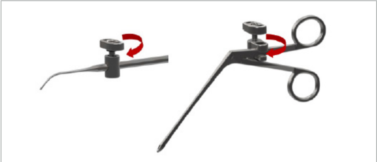
图 87 (左) – 将 2-6 mm 仪器钳 (REF 8000-060-010) 固定至手术仪器
