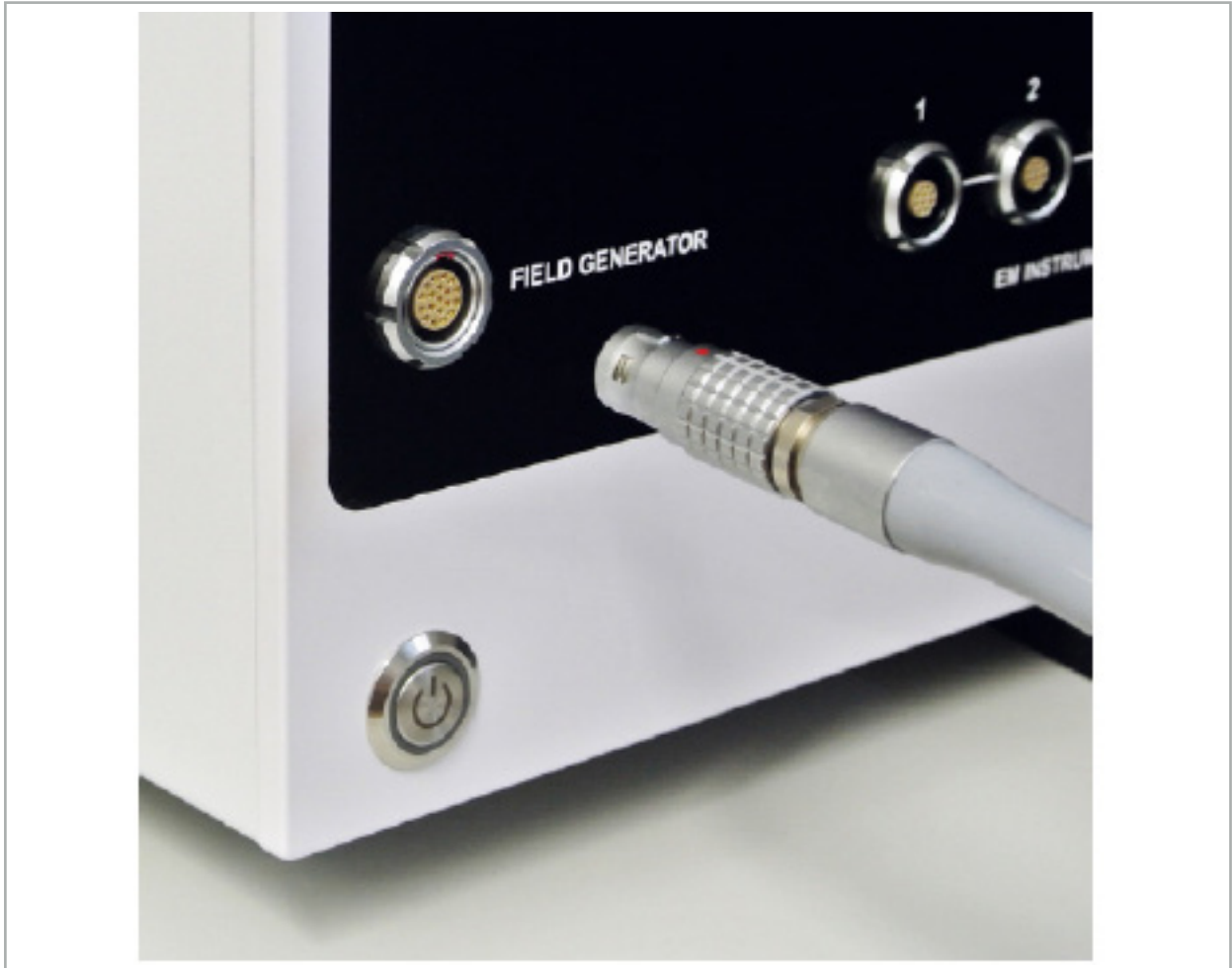
图 65 – 将磁场发生器缆线连接至电磁导引装置
