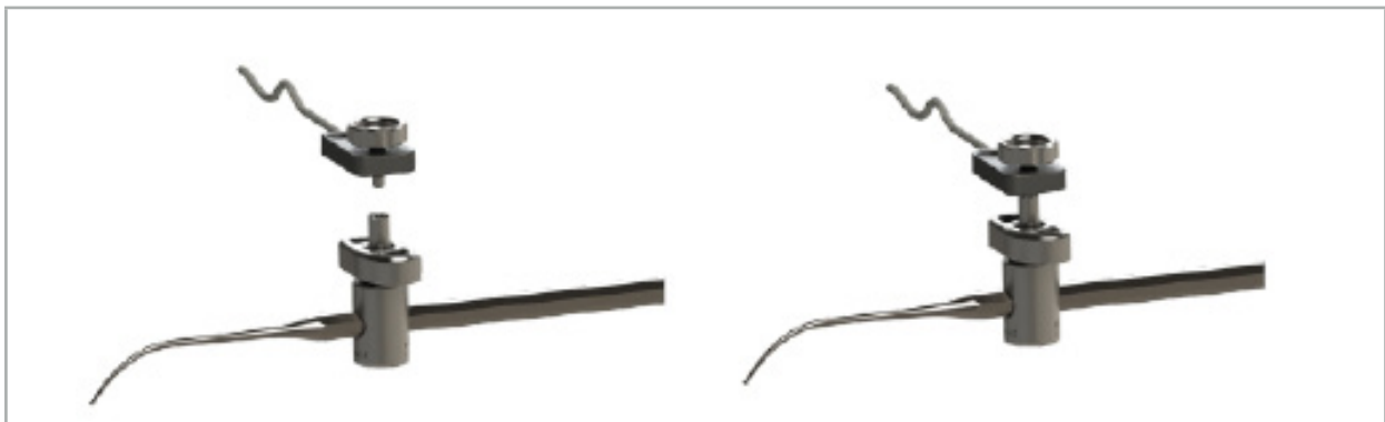
Figur 78 – Förberedelse av instrumentklämma med universell elektromagnetisk spårare
