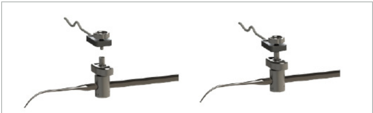
Figura 78: Preparación de la pinza de instrumento con el tracker universal electromagnético
