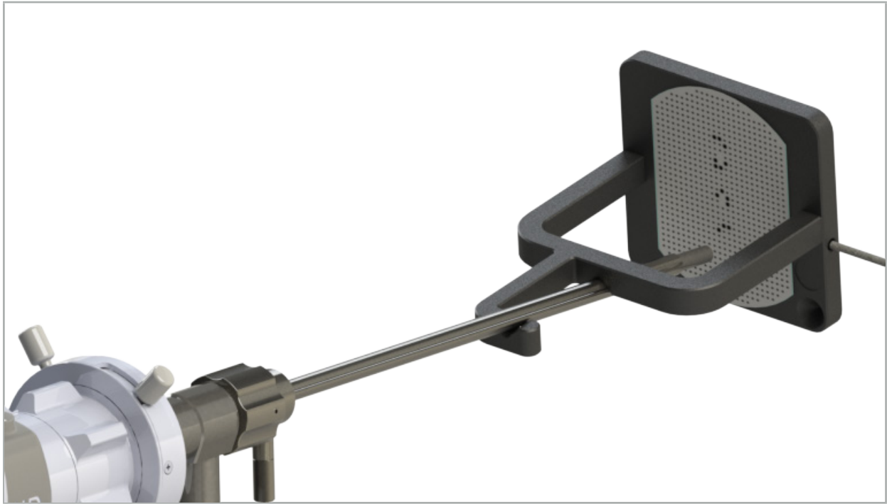
Figura 101: Endoscopio guiado con navegación en el cuerpo de calibración electromagnético
