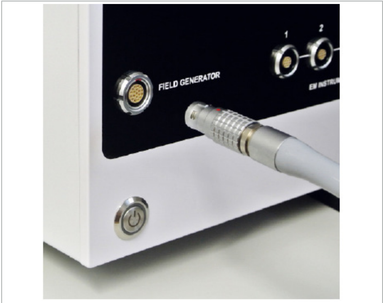
그림 65 – 전자기 항법 장치에 전자기장 발생기 케이블 연결
