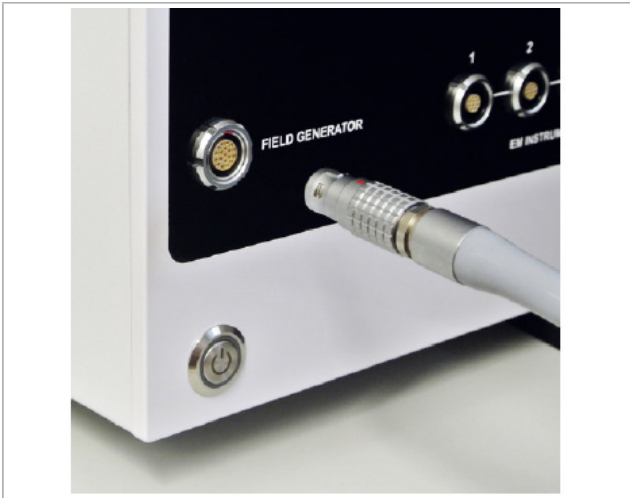
Εικόνα 65 – Σύνδεση του καλωδίου της γεννήτριας πεδίου στη μονάδα ηλεκτρομαγνητικής πλοήγησης
