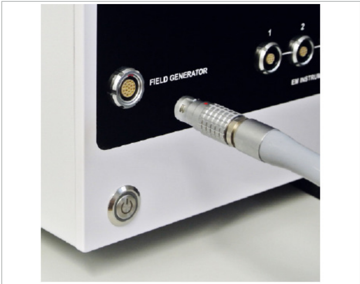
Figura 65 – Collegamento del cavo del generatore di campo all'unità di navigazione elettromagnetica
