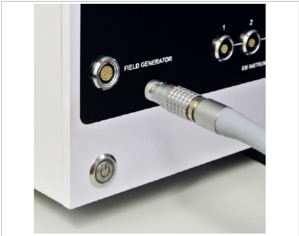
Figure 65 – Branchement du câble du générateur de champ à l'unité de navigation électromagnétique
