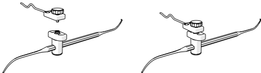
Abbildung 2: Befestigen des elektromagnetischen Universaltrackers an der Instrumentenklemme
