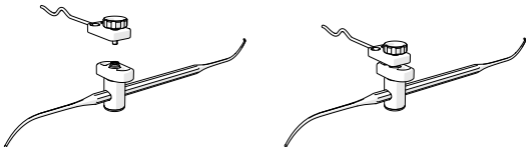
Şekil 2: Elektromanyetik Üniversal İzleyicinin Alet Klempine Monte Edilmesi
