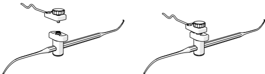
Figura 2: Montaggio del tracker universale elettromagnetico sul morsetto per strumenti
