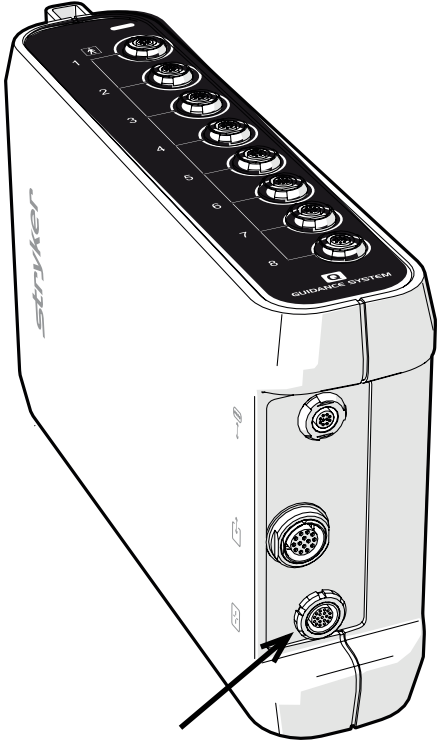
Şekil 4 – Saha Jeneratörünün EM Alet Adaptör Kutusuna Bağlanması
