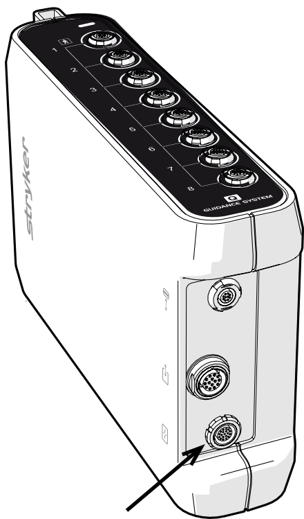
Рис. 4. Подключение электромагнитного генератора к блоку адаптера для электромагнитных инструментов
