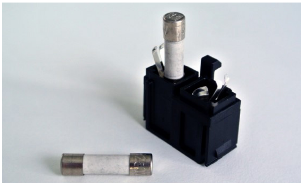
Figura 6: Colocación de los fusibles
