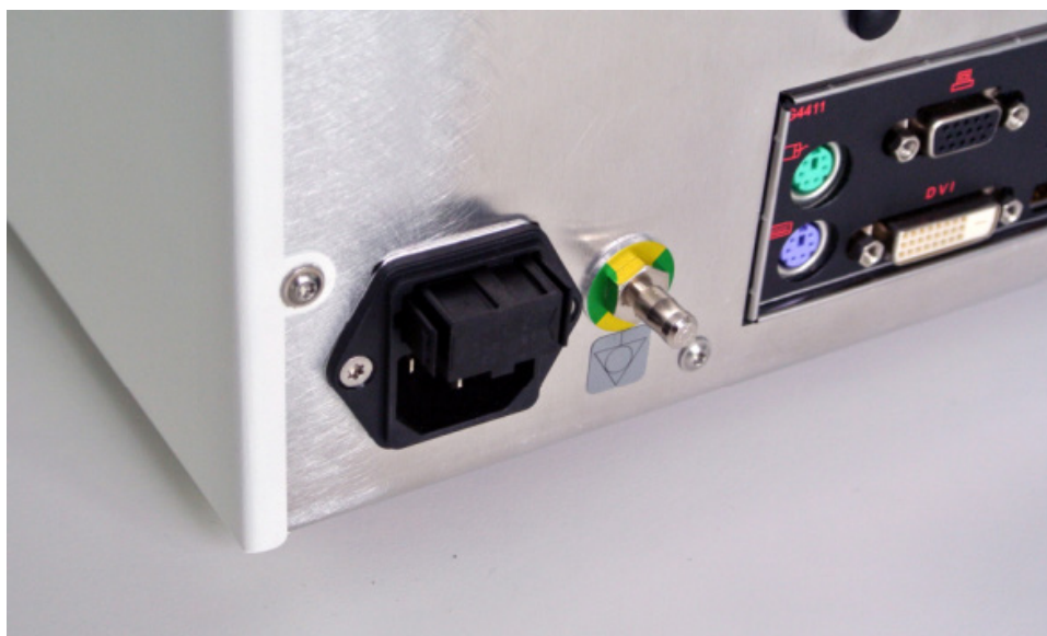
Figura 4: Abertura da caixa de fusíveis
