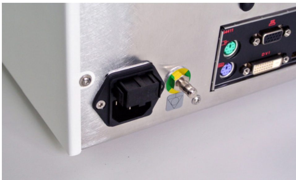
Figure 4 : ouverture de la boîte à fusibles
