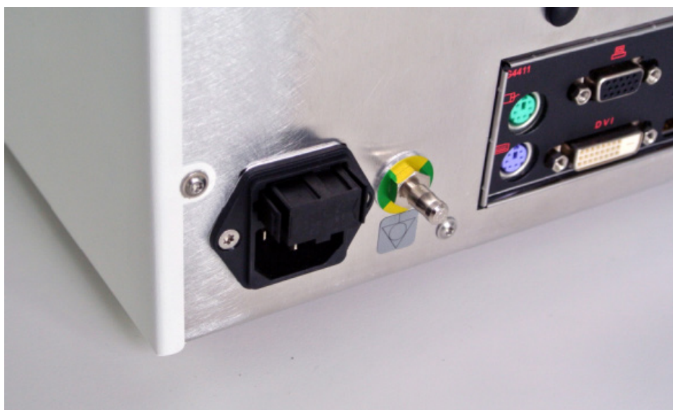
Figura 4: Apertura de la caja de fusibles
