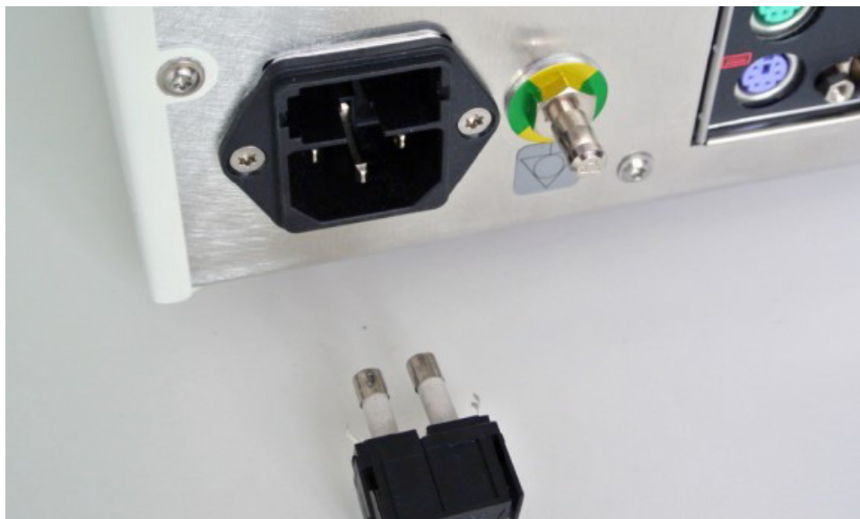
Figur 5: Fjernelse af sikringsholderen
