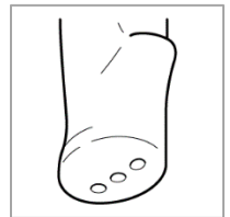
Figur 4: Kryogengass kommer ut fra portene på bunnen av kryoproben.
