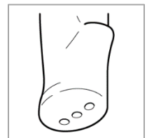
Figura 4: El gas criogénico sale por los puertos de salida situados en la parte inferior de la criosonda.
