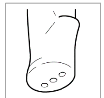
그림 4: 한제 기체는 냉동 프로브 바닥의 배기구에서 배출됩니다.
