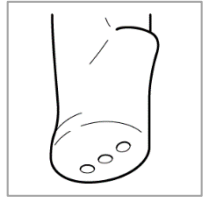
图 4: 冷冻剂气体从冷冻探头底部的排气口排出。
