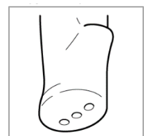
Abbildung 4: Kältemittelgas tritt aus den Auslassöffnungen an der Unterseite der Kryosonde aus.
