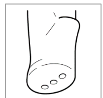
Figura 4: O gás criogénico sai pelas portas de exaustão na parte inferior da criossonda.
