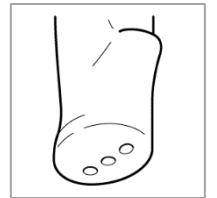
Şekil 4: Kriyojen gaz, kriyoprobun tabanındaki egzoz portlarından dışarı çıkar.
