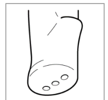
Figur 4: Kryogen gas kommer ut ur luftningshålen på undersidan av kryosonden.
