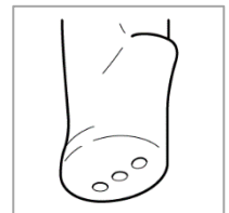
Afbeelding 4: cryogeen gas komt uit de uitlaatopeningen in de onderzijde van de cryoprobe.
