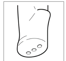
Kuva 4: Jäädytinkaasu poistuu jäädytyskärjen kahvan alaosassa olevista poistoaukoista.
