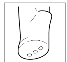
Figure 4 : Le cryogène sous forme gazeuse sort par les orifices d'échappement par la face inférieure de la cryosonde.
