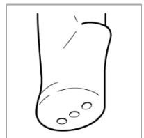
Figur 4: Kryogengas udledes fra udstødningsportene i bunden af kryosonden.
