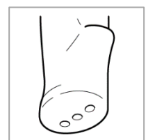
Figura 4: Il gas criogenico fuoriesce dai fori di scarico situati nella parte inferiore della criosonda.
