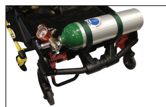
Porta-bombola O 2 estremità superiore (sezione retraibile)
