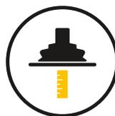
Profundidade ajustável: 45 a 53 ± 2 mm (fixado durante a operação)
