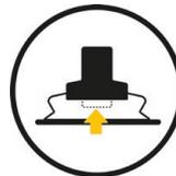
Druckplattenfreigabe um 10 mm, um das Anheben der Brust während der Beatmung zu ermöglichen
