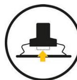
Relâchement du tampon de pression optionnel (10 mm/0,4 po) pour permettre le soulèvement thoracique pendant la ventilation
